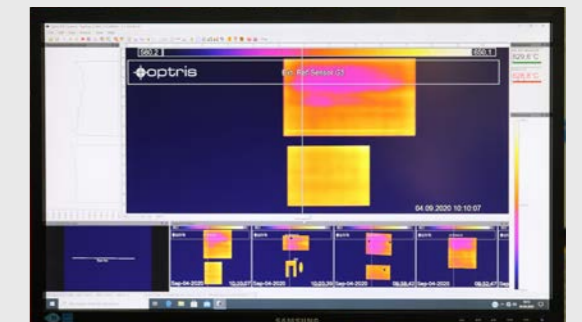
Monitoreo de temperaturas de láminas de vidrio
