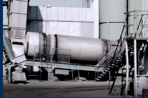
Ejemplo de aplicación: horno rotatorio en la industria química
