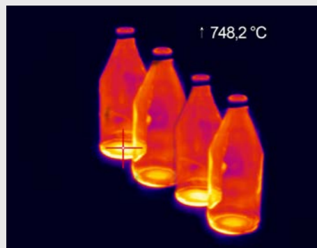
Medición de puntos calientes en la producción de botellas de vidrio
